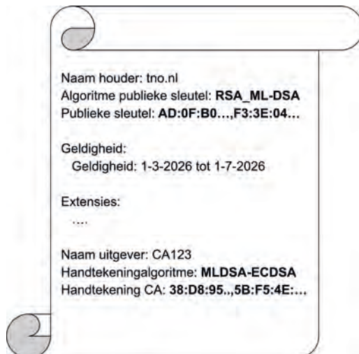
Figuur 7: Digitaal certificaat van type compositie sleutels en handtekening (gesimplificeerd).
